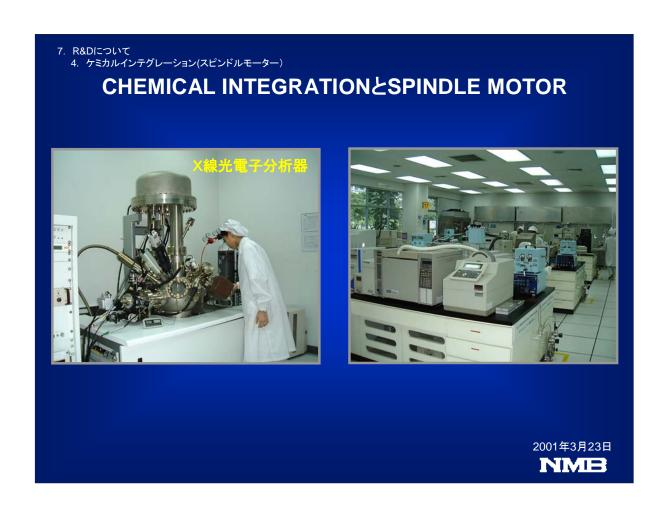
左の写真は、50オングストローム程度の極表面を分析するX線光電子分析器です。
